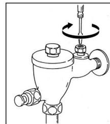
① マイナスドライバーで止水栓を閉め、強制作動ボタンを押して、水が出ないことを確認してください。
