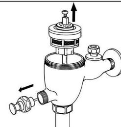
3. フラッシュバルブの内部にあるピストンバルブと押しボタンを取外します。(取外した部品は保管しておいてください)
