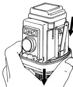
③ 付属の下カバー取外し用平板を図のように片側ずつ差し込んで下カバーを外します。
