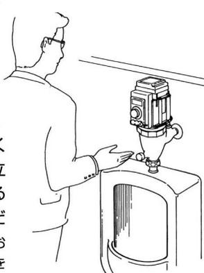
※電池装着後検知表示の点灯時間は、約10分間です。点灯時間内に調整できなかった時は、電池を外し40秒以上放置してから再度電池を装着してください。再度約10分間点灯します。
