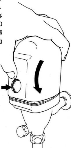
⑫ 表カバーを手前に引きつけながらセンサー穴を本体のセンサー窓に合わせ、図のようにカチッと音が出るまで差し込んでください。
