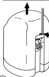
① 付属品の六角レンチ(2mm)をカバーロック穴に差し込むとロックが外れて表カバーがポップアップします。
