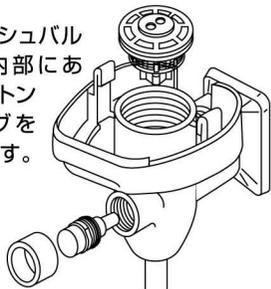
5. 押しボタンを外します。(取外した部品は保管しておいてください)
