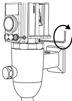
② 付属品の六角レンチ(2mm)で固定ネジを適度に締め付けます。
