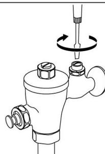
1. マイナスドライバーで止水栓を閉め、押しボタンを押しても水が出ないことを確認します。
