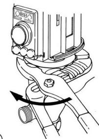
⑥ 固定ナットを手締めし、パイプレンチ(またはスライドレンチ)等の工具で本体がゆるまない程度に締め付けます。
