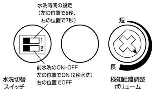
■前水洗ON・OFFおよび水洗時間の設定を変更する時は、電池を外して40秒以上放置してから再度電池を装着してください。
