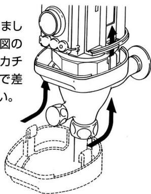
⑪ まず止水栓を開いてください。本体の前に立って適正に水洗されるかテストを行ってください。(この時水洗時間および前水洗のON・OFFを設定してください)
