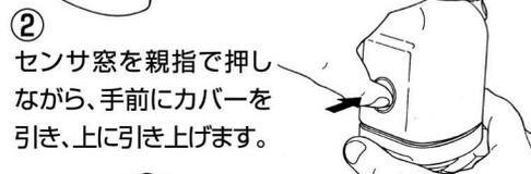
② センサ窓を親指で押しながら、手前にカバーを引き、上に引き上げます。
