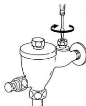
1. マイナスドライバーで止水栓を閉め、押しボタンを押しても水が出ないことを確認します。
