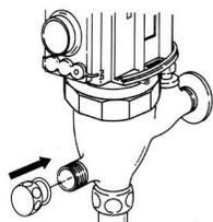
⑨ 電池キャップの両側をつまんで外し、リチウム電池 (CR-P2) を図の向きに入れ、電池キャップを元に戻します。(カチッと音が出るまで)
