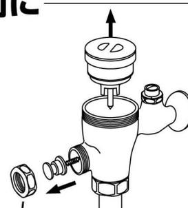
3. フラッシュバルブの内部にあるピストンバルブと押しボタンを取外します。(取外した部品は保管しておいてください)
