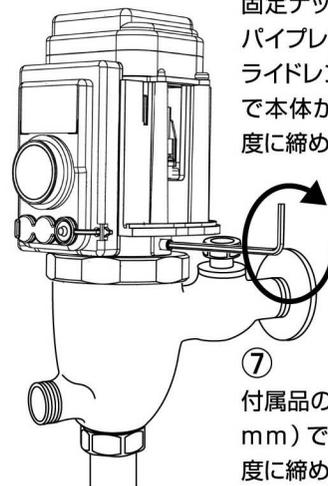
⑦ 付属品の六角レンチ(2mm)で固定ネジを適度に締め付けます。
