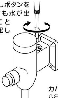
2. カバーを手で回し外します。スパナなどでキャップを左に回して取り外します。
